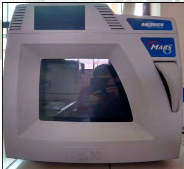
FIGURA 2.2. Digestor microondas MARS utilizado para realizar las digestiones de raíces y hojas de Bacopa monnieri L. (Hisopo de agua).
