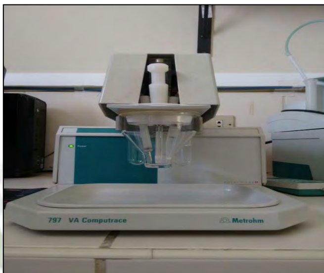
FIGURA 2.1. Estación voltamperométrica 797 VA Computrace utilizado para la determinación de selenio (IV).
